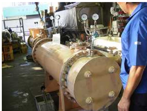
23 管側耐圧検査
