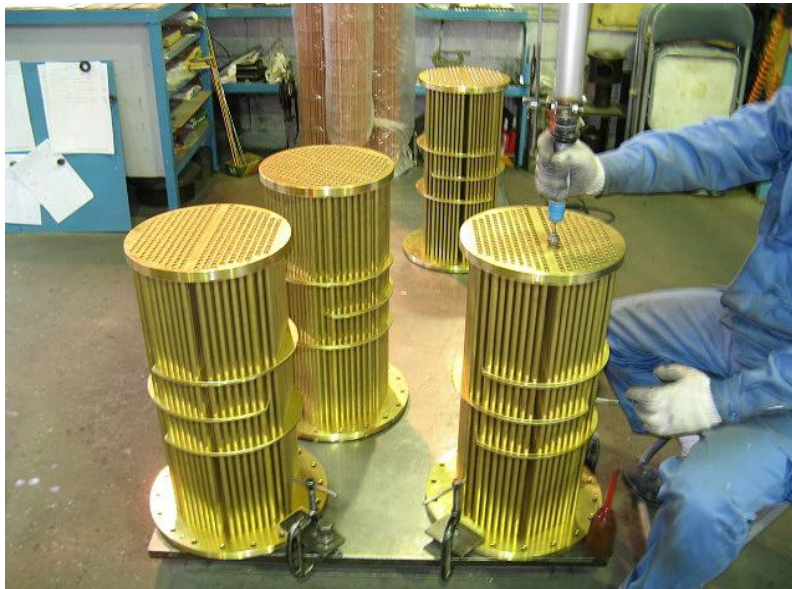
拡管工程 冷却管を拡管し、管板に 固着させる。
