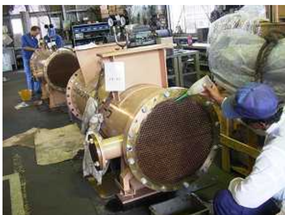
12 冷却管気密検査
