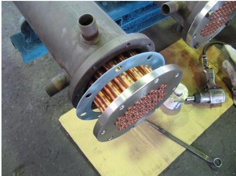
管束挿入状況
