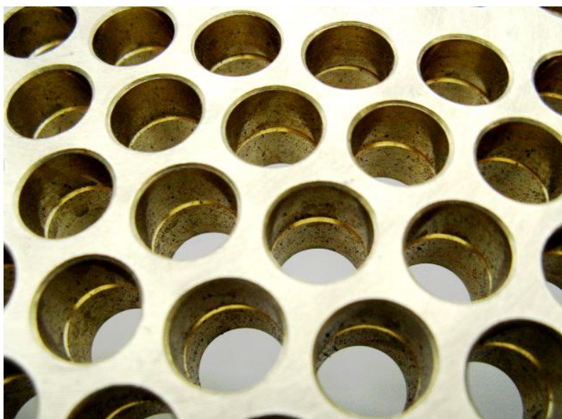
管板加工例② グループ(溝)加工: 拡管 により管は溝に食い込み 固着力が増し、高い気 密性が得られる。
